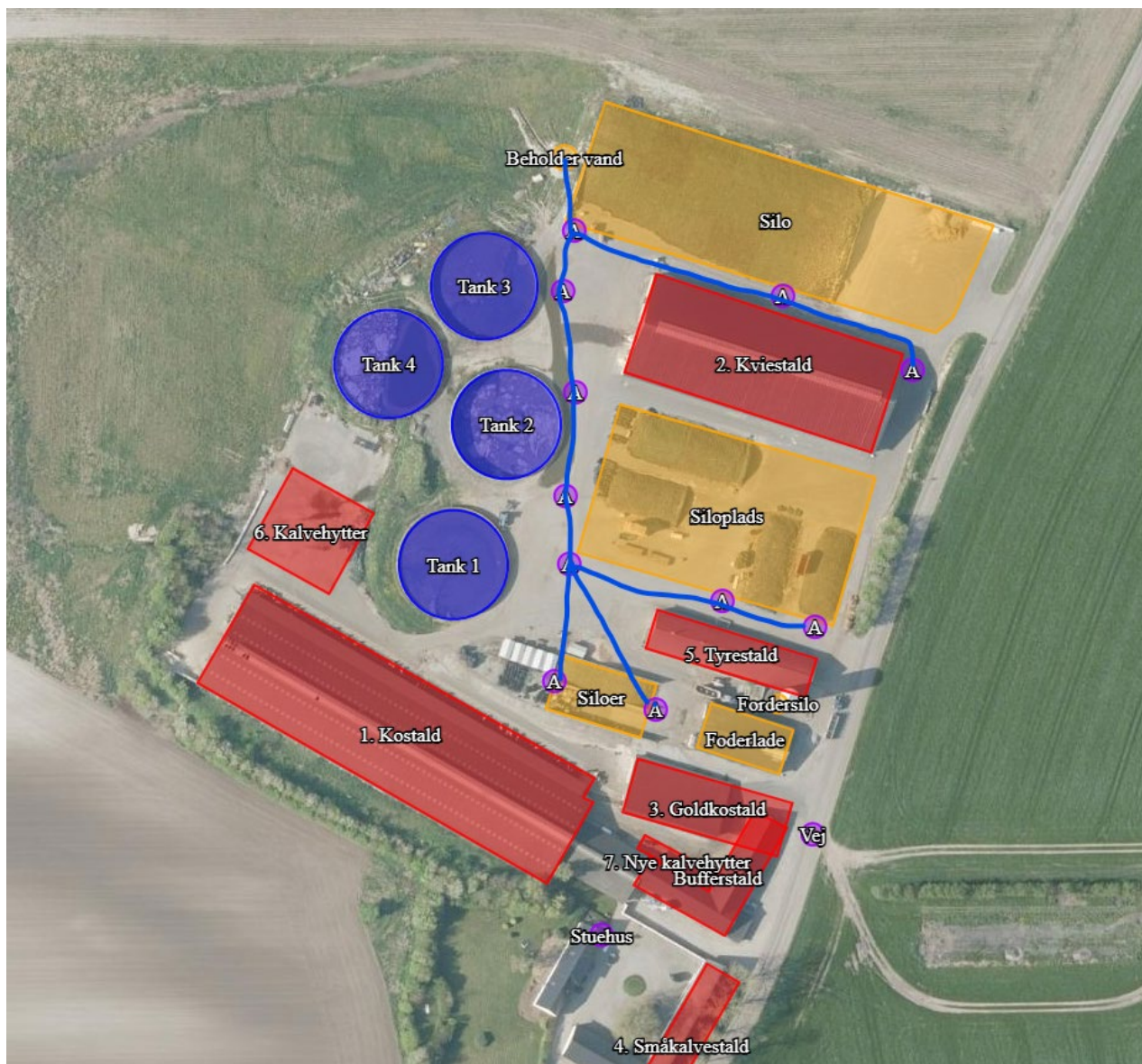
Vandledninger til udsprinklingsanlæggets beholder. A, viser afløb. Den blå streg viser forbindelsen mellem afløb og til beholderen med vand.
