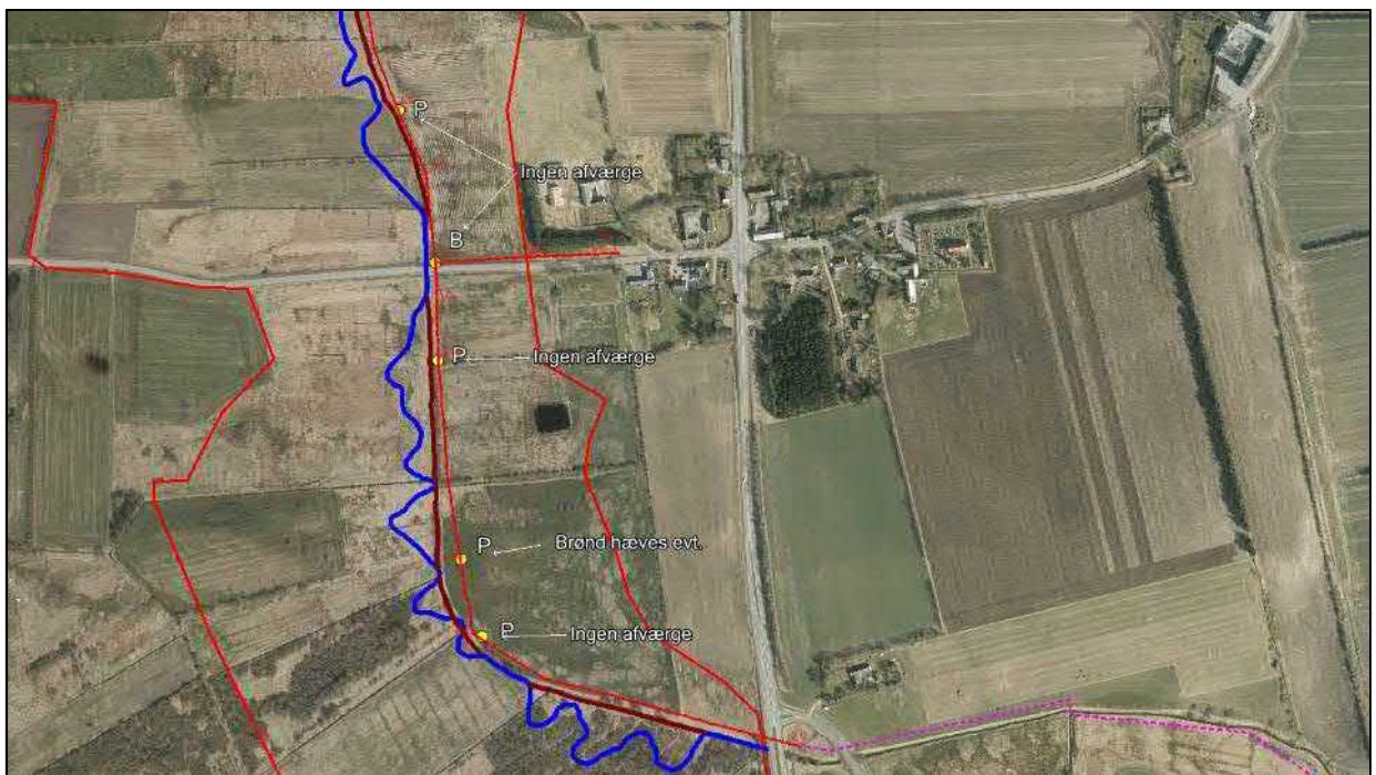
Figur 75. Rensebrønde på spildevandsledning langs Skibsted Å.
