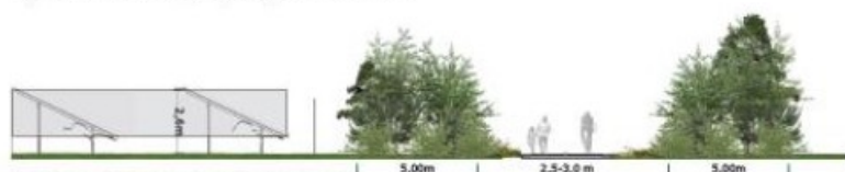
SNIT B1-B1 (ALT.) I GRUSVEJ, ØST-VEST MED SKÆRMENDE 3.) BEPLANTNINGSBÆLTE, 5 RK., I BEGGE SIDER ELLER 5 M'S BÆLTE MOD LANDSKAB
