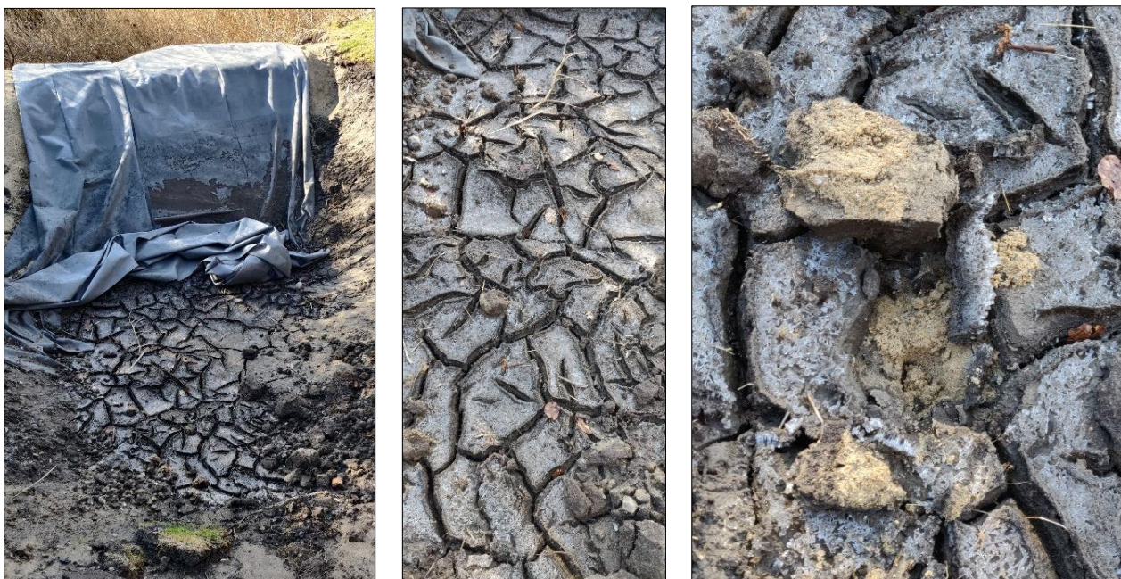
Figur 7-12 Billede efter knap 14 dages afvanding af sedimentet i pilotforsøg.
