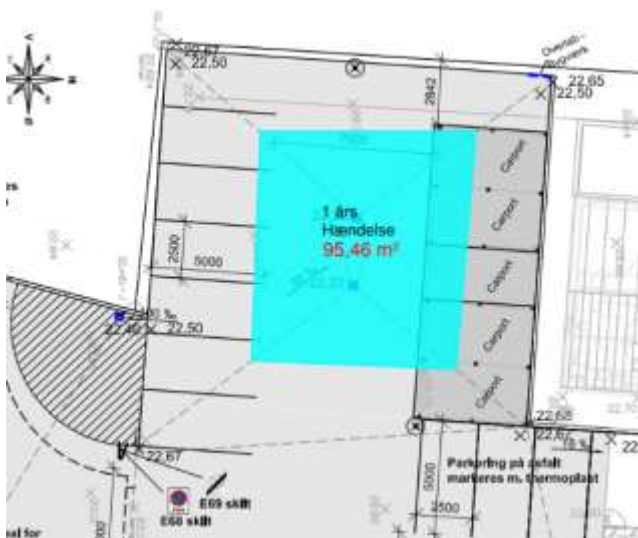
Opstuvningsareal ved 1-års hændelse 95,46m 2 Tømmetid 7 minutter
