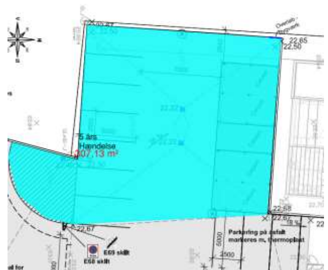
Opstuvningsareal ved 10-års hændelse 307m 2 Tømmetid 37 minutter
