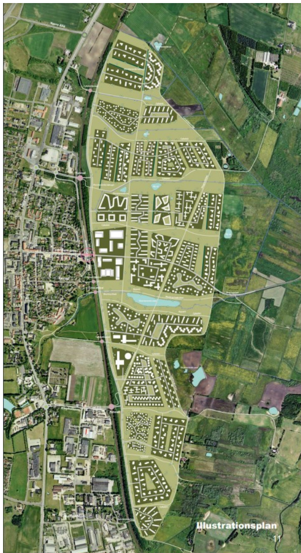
Figur 12: Viser en illustrationsplan fra dispositionsplanen for udbygning af Støvring Ådale. Princippet er, at boligområderne strækker sig hele vejen på tværs af projektområdet mellem banen og det bevaringsværdige landskab. Til gengæld sikrer de grønne kiler kig mod ådalen og luft mellem boligområderne.
