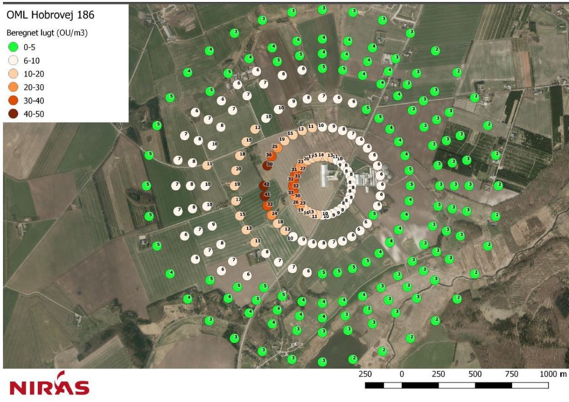
Lugtemission fra husdyrbrug på Hobrovej 186.
