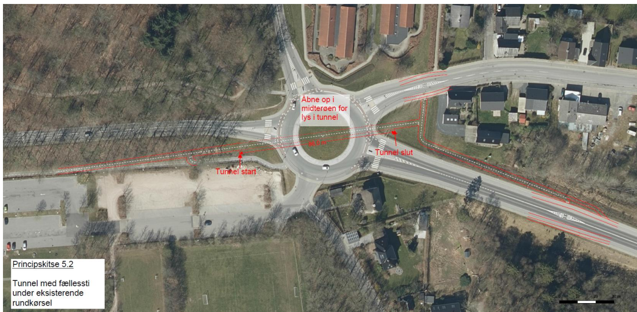
Figur 3.7. Principskitse 2 af stitunnel under den eksisterende rundkørsel med adgang på hjørnet af Himmerlandsvej og Under Broen.
