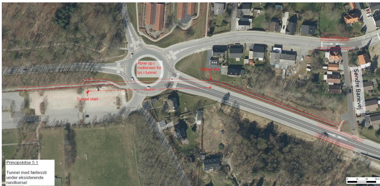
Figur 3.6. Principskitse 1 af stitunnel under den eksisterende rundkørsel med adgang via sti langs Under Broen.
