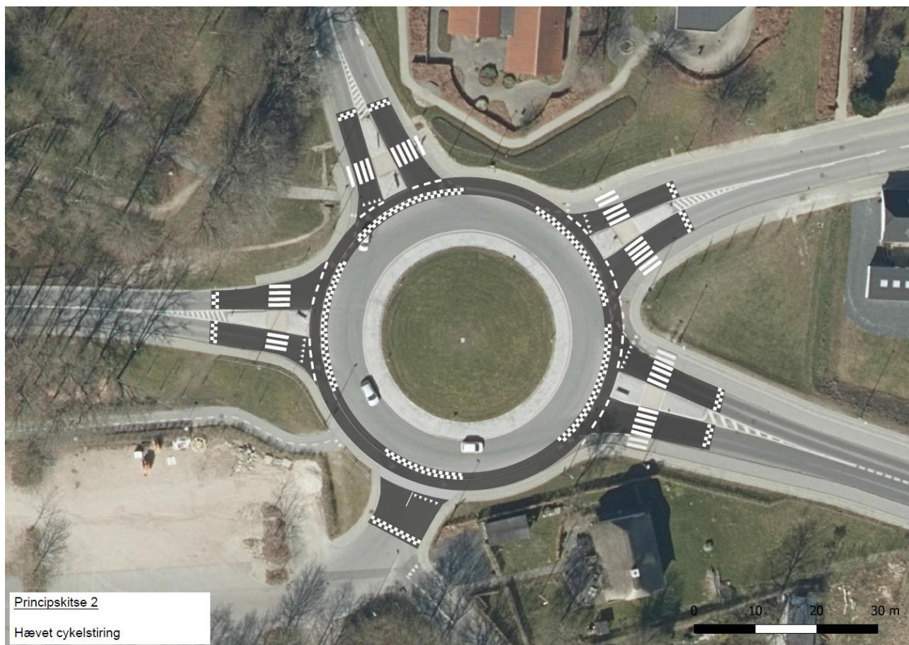
Figur 3.3. Principskitse med hævet cykelstiring og hævet flade på til- og frafarterne.
