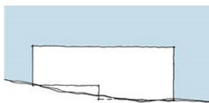
Bebyggelse opført i forskudte planer på mindre kuperet terræn.
