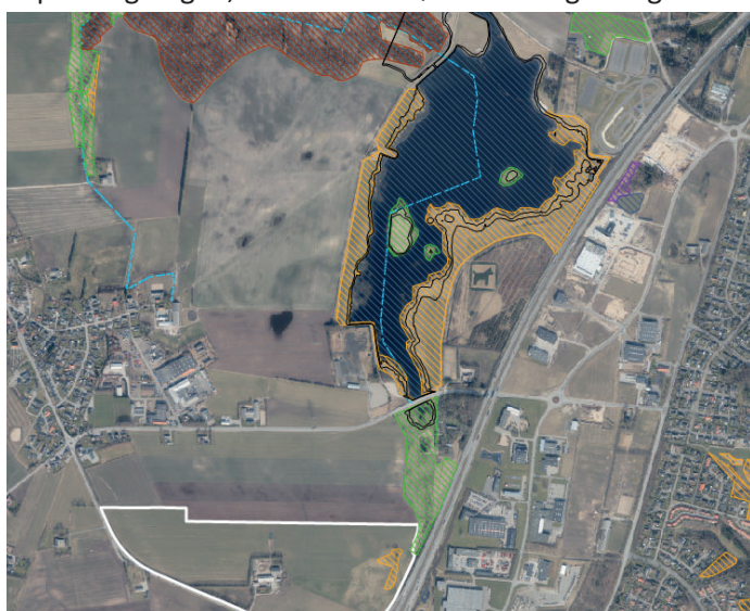
Figur 11 - Figuren til tv. viser udbredelse af Juelstrup Sø ved et vandspejl i kote 42,15 m vist med sort linje. Figuren th. viser det højeste målte vandspejl i kote 41,7 m (den inderste sorte linje). Beskyttet natur er vist med skravering, gul er overdrev, grøn er eng og rød er mose.
