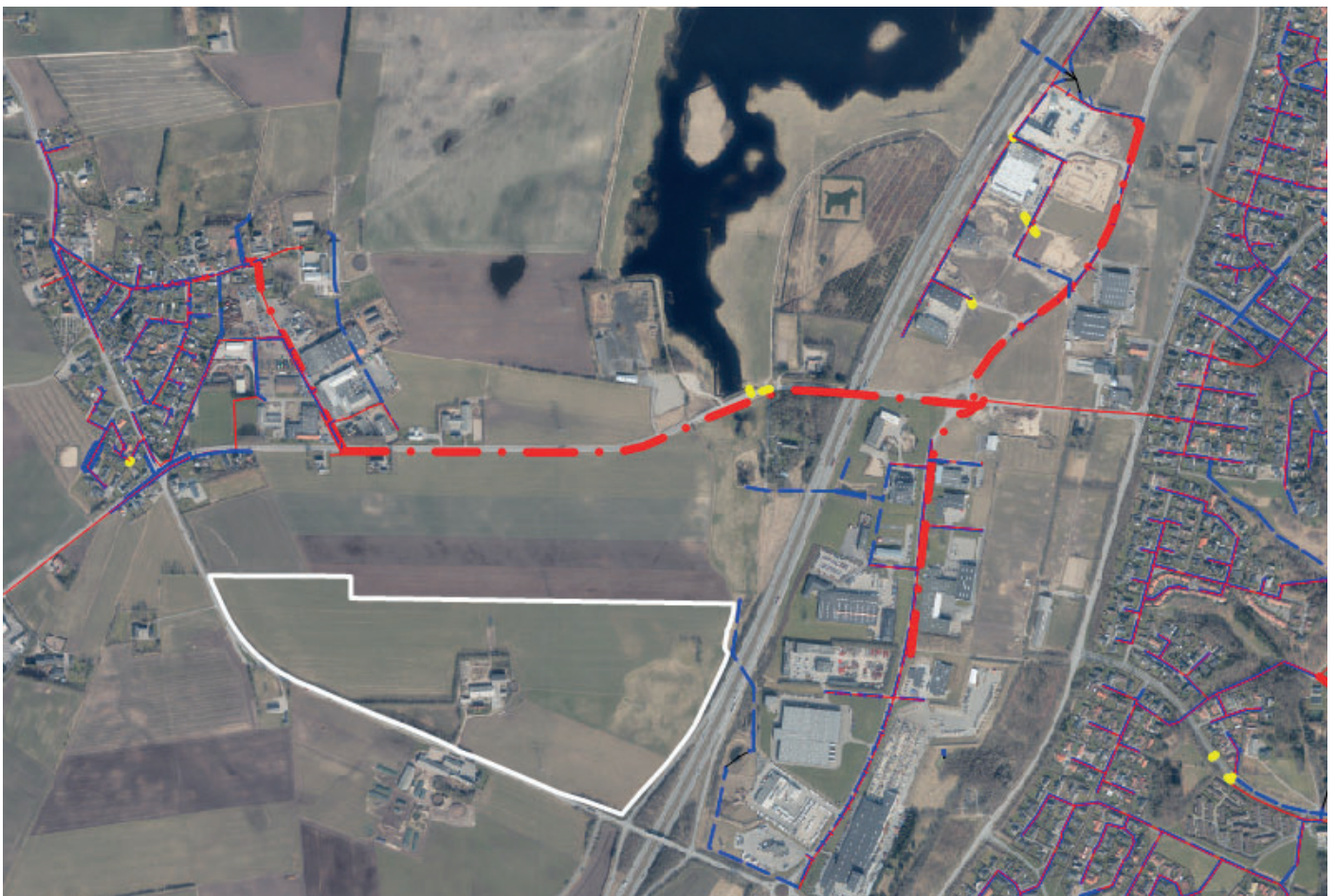
Figur 10 - Kort som viser eksisterende regnvandsledninger (vist med blå linjer) som leder overfladevand til Juelstrup Sø. Lokalplanområdet er vist med hvid linje og spildevandsledninger vist med rød.
