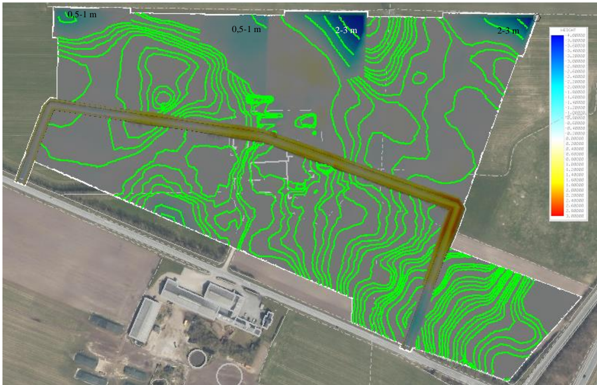
Figur 7: Udklip af bilag 5. Af bilaget fremgår hvor der sker afgravning og påfyldning med hhv. gule og blå nuancer.
