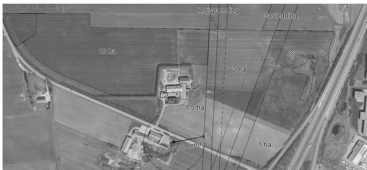
Figur 3. Projektområdet. De 2 sorte skraveringer mod øst og vest er areal udlagt til teknisk anlæg. Den brune strimmel langs Nibevej er en 20 m. bred støjvold. Gasledning og højspændingsledninger er vist med hhv. 40 m og 28 m respektafstande. De orange områder er 2 irregulære områder, der ikke er velegnet til byggeri. Det blå område viser det reelle område, der kan anvendes til lokalplanens formål.
