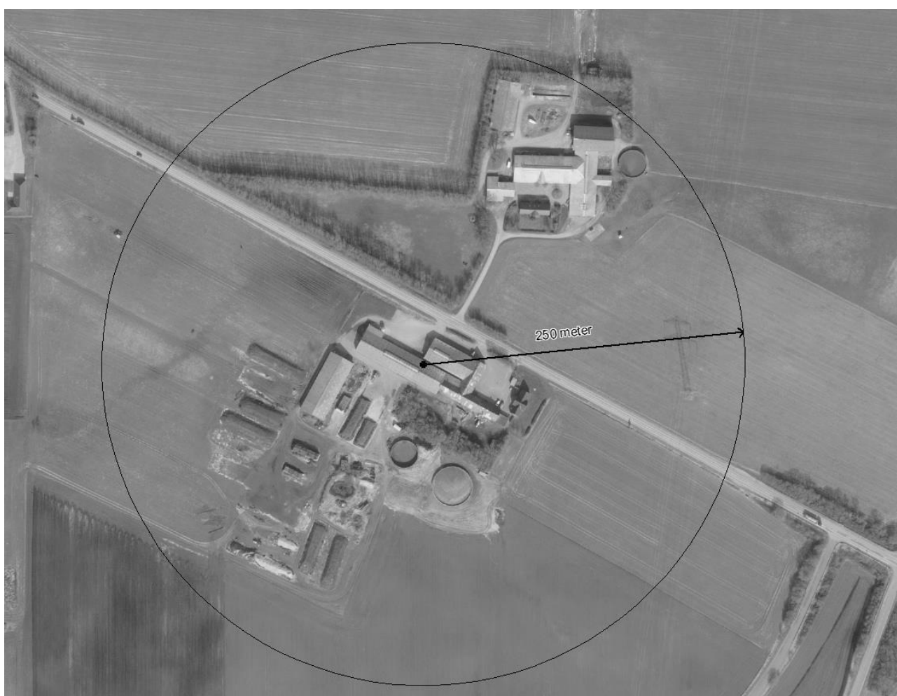
Figur 1. Cirklen viser en radius på 250 meter omkring et estimeret lugtcentrum, der er vist med en sort prik.
