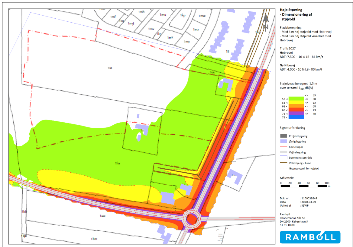
Figur 13: Udbredelse af trafikstøj, L_{den} , fra Hobrovej og Ny Nibevej ind i boligområdet med støjvold på 4 m etableret ud for Hobrovej. Udbredelsen er vist i højden 1,5 meter over terræn. (Rambøll, 2020)
