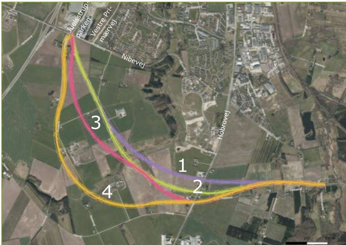
Figur 1. Linjeføringer for de fire forskellige forslag til ny vejforbindelse.
