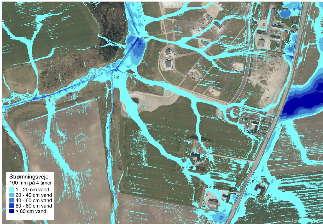
Figur 21. Strømningsveje på eksisterende terræn.
