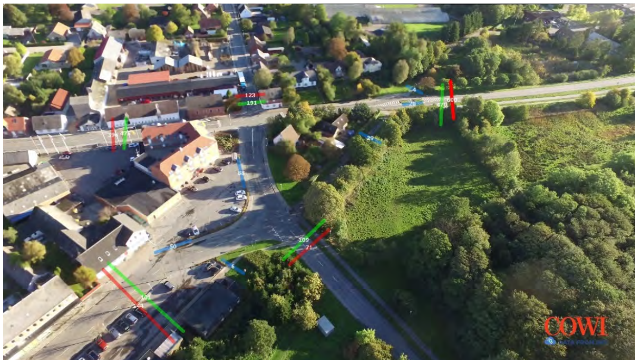
Figur 7 Tællesnit for ind- og udkørende trafik. Det grønne snit angiver indkørende, det røde snit angiver udkørende, og de blå snit angiver både ind- og udkørende.
