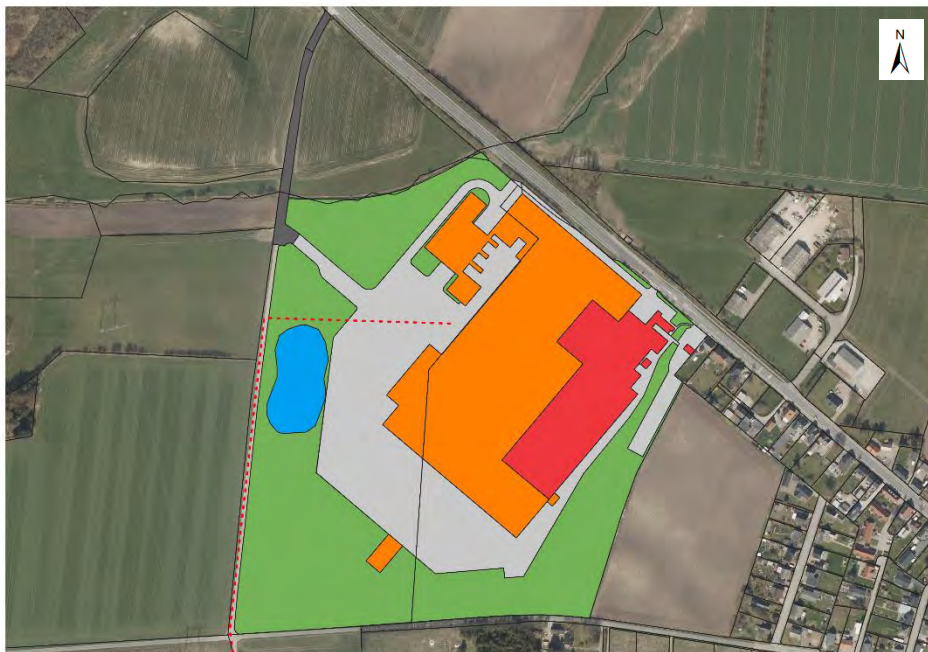
Figur 4.1: Oplandsinddeling af projektområde samt et udsnit af Rebild Forsynings eksisterende spildevandsledning, som krydser matriklen.
