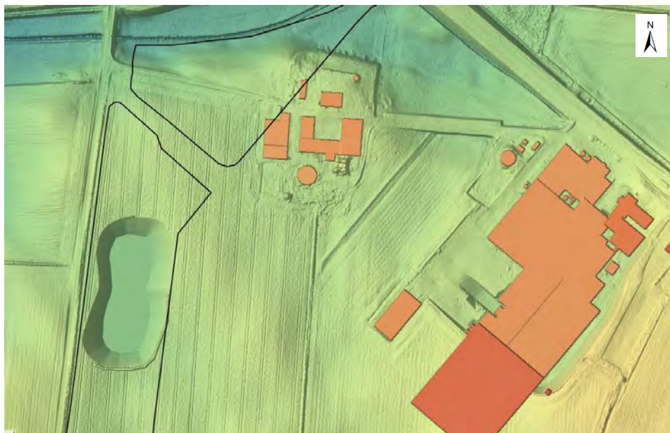
Figur 4.3: Forslag 2 - bassin syd for eksisterende spildevandsledning på 8633 m 3 .
