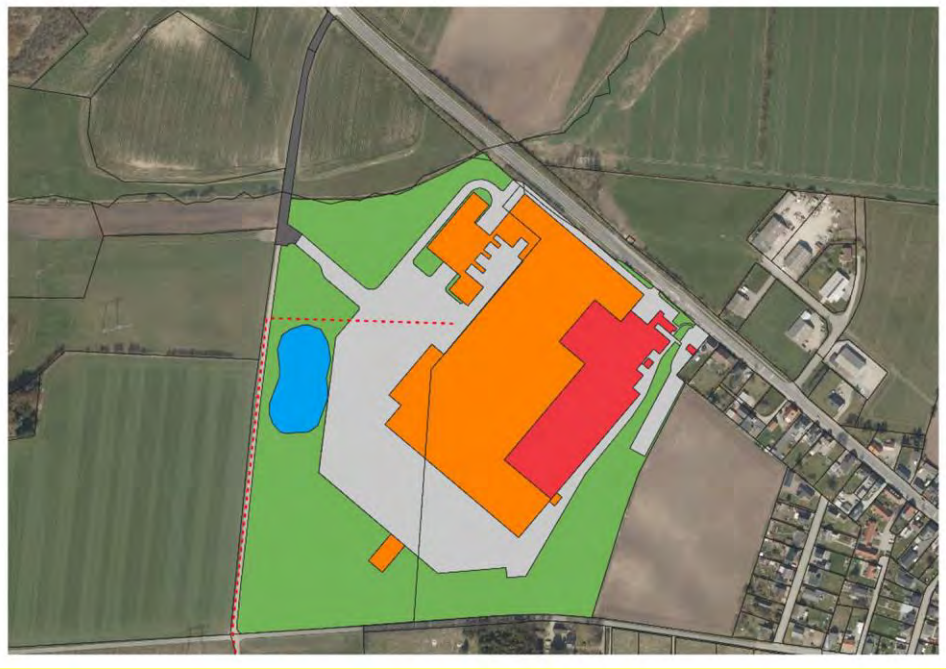
Figur 6.5: Vurdering af mulig placering af regnvandsbassin inden for lokalplansforslagets delområde 1. Rød/orange er bygninger, grøn er grønne arealer, grå er veje/parkeringspladser, blå er regnvandsbassin. Den stiplede røde linje viser beliggenheden af Rebild Forsynings eksisterende spildevandsledning.
