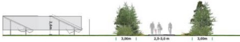
SNIT B1-B1 I GRUSVEJ, ØST-VEST MED SKÆRMENDE 3.) BEPLANTNINGSBÆLTE, 3 RK., I BEGGE SIDER
