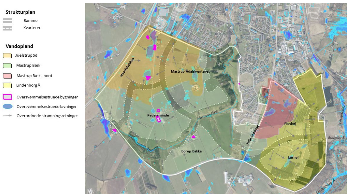
Figur 5-24. Figuren viser afstrømningsområder, vandskel, afstrømningsretninger og nuværende oversvømmelsestruede bygninger inden for Strukturplanens område ved en 50 års nedbørs hændelse.
